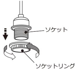
②下図のようにセードにソケットをはめこみソケットリングを時計回りにまわしてセードを固定してください。
