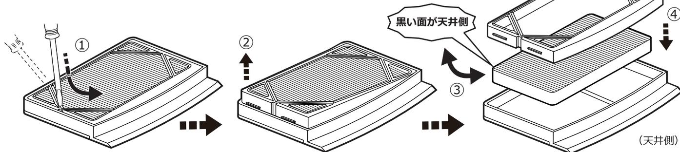
①フィルターカバーの穴にドライバー等を差し込み、上に持ち上げるようにします。
